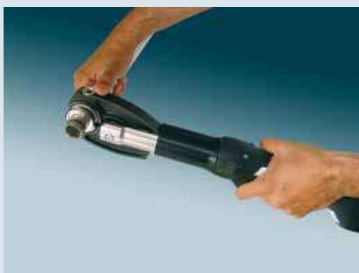
Joonis 9-1: Press-fitting tööriistaga.
