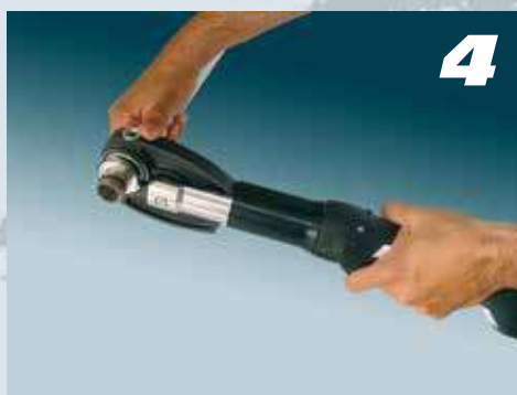
Joonis 7-10: Paigaldage press ja pressige kokku.
