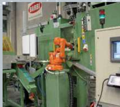
Joonis 7-5 Messingu mehaaniline töötlemine
